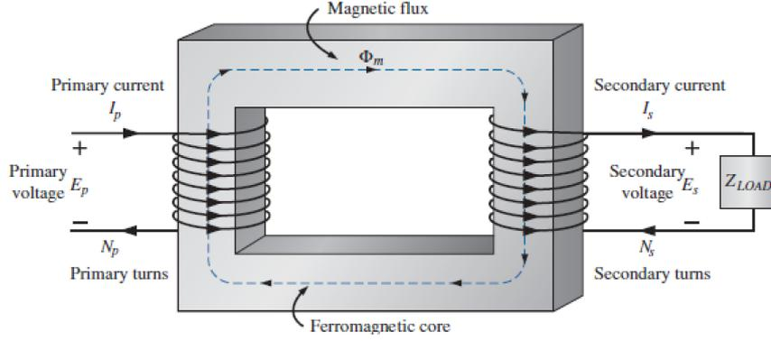
عندما يتم إثارة الملف الابتدائي بجهد متناوب، يتولد تيار متناوب منتجاً فيضا مغناطيسياً  $\Phi$ . يحتوي الملف الابتدائي على عدد  $N_p$  من اللفات. يؤدي الفيض المغناطيسي المتناوب  $\Phi$  المرتبط بالملف الابتدائي إلى إحداث قوة دافعة كهربائية  $E_p$ . يرتبط الفيض المغناطيسي بالملف الثانوي من خلال القلب المغناطيسي المشترك وتولد القوة الدافعة الكهربائية المحتثة  $E_s$  في الملف الثانوي حسب مبدأ الحث.
