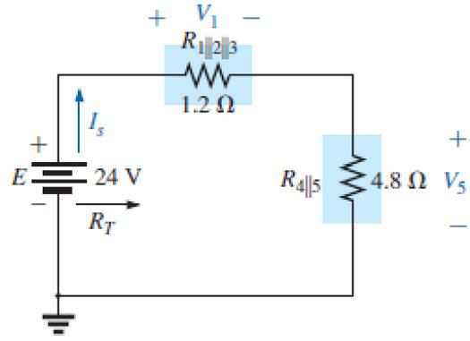
مثال: للدائرة الموضحة ادناه احسب الفولتيات  $V_1$  ،  $V_3$  ،  $V_{ab}$  ثم احسب التيار الكلي  $I_s$ .
