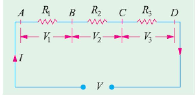
مثال: الدائرة الموضحة بالشكل أدناه، احسب المقاومة الكلية للدائرة، التيار الكلي،  $V_1$ ،  $V_2$ ،  $V_3$ ، القدرة المتبددة في كل مقاومة، القدرة المجهزة من المصدر.
