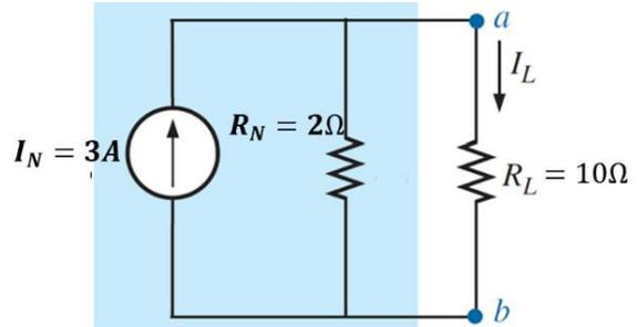
مثال: أوجد التيار خلال المقاومة  $R_L$  للدائرة الموضحة بالشكل باستخدام نظرية نورتن.
