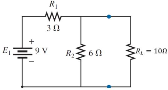
$$R_{Th} = R_1 \parallel R_2 = \frac{(3 \Omega)(6 \Omega)}{3 \Omega + 6 \Omega} = 2 \Omega$$
