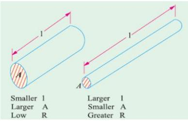
$\rho$ : هي المقاومة النوعية للمادة وتعطى بالأوم.متر ( $\Omega \cdot m$ )
