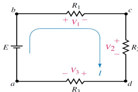
مثال: للدائرة الموضحة بالشكل ادناه احسب  $V_2$  باستخدام قانون كيرشوف للفولتية ثم احسب  $I$ ,  $R_1$ ,  $R_2$ .
