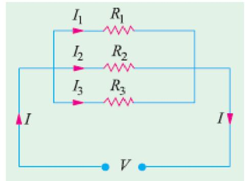
مثال: ربطت المقاومات  $R_1, R_2, R_3$  على التوازي مع مصدر جهد 45V كما موضح في الشكل. احسب المقاومة المكافئة للدائرة، التيار الكلي، فرق الجهد عبر كل مقاومة والتيار المار في كل مقاومة.
