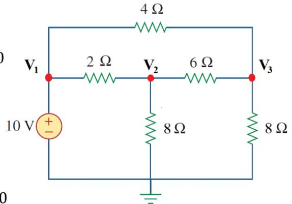
$$\begin{bmatrix} 19 & -4 \\ -4 & 13 \end{bmatrix} \begin{bmatrix} V_2 \\ V_3 \end{bmatrix} = \begin{bmatrix} 120 \\ 60 \end{bmatrix}$$
