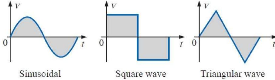
**الشكل الموجي (الموجة) Waveform:** المسار الذي يتم تحديده بواسطة كمية ما، مثل الجهد أو التيار المرسوم كدالة للزمن (كما هو مذكور أعلاه).
