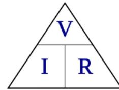
**مثال:** مقاومة قيمتها  $10 \Omega$  في دائرة كهربائية فرق الجهد بين طرفيها  $5 \text{ V}$  ما شدة التيار المار خلال المقاومة؟
