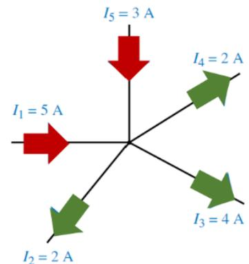
مثال: احسب التيارات  $I_1$ ,  $I_3$ ,  $I_4$ ,  $I_5$  للشبكة الموضحة في الشكل ادناه.
